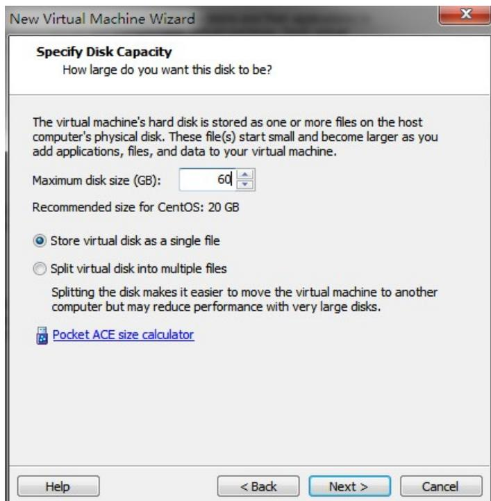
这里指定的磁盘大小并不是虚拟机实际占用磁盘大小，而是它最大使用量，实际值会根据在虚拟机中安装的软件的多少进行动态的变化，所以指定大点没有关系，只要你实际在虚拟机里面不要太狠装太多东西，呵呵。
