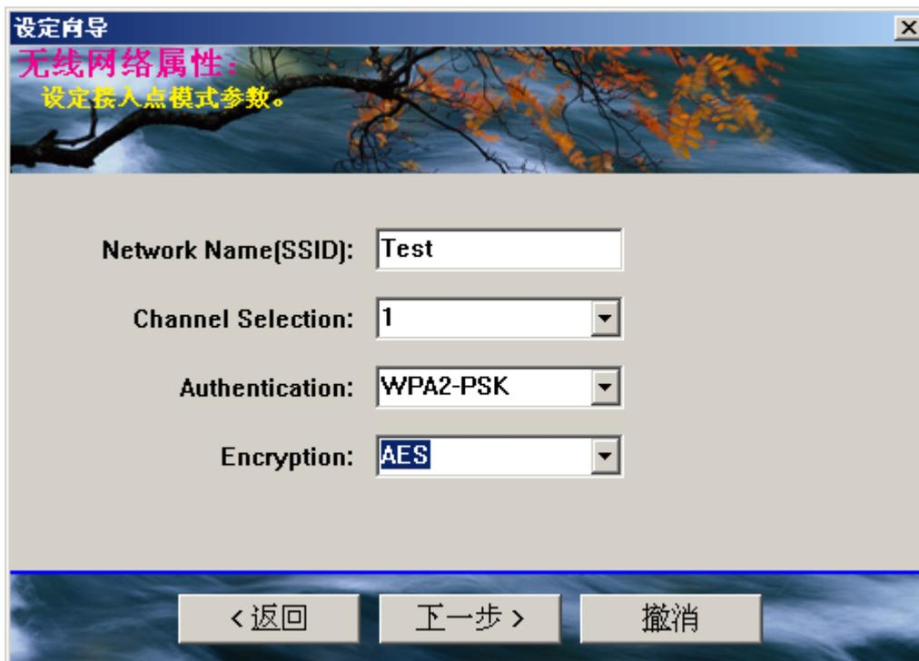
**Network Name(SSID):**设置无线网络名字，此项可随便设置，网卡通过此名字连接到软 AP 卡王。这里设置为：“TEST”，这里 SSID 只能为 ACSII 码，用户可输入英文或数字，请勿使用中文。
